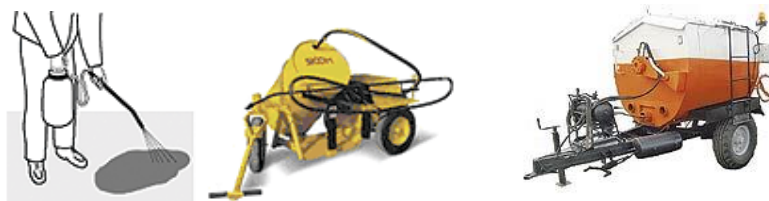
Rasm 6.41. Pastki va devorlarni suyuq (issiq) yoki suyultirilgan bitum yoki bitum o'z ichiga olgan emulsiya qatlami bilan ishlov berish
